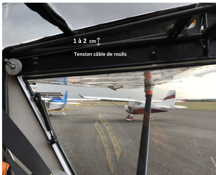
Tension câble de roulis (1)
